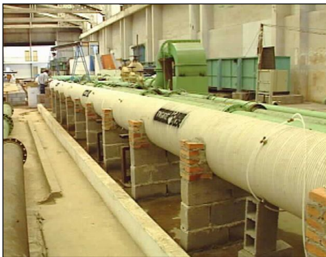
Ensaio da Rugosidade de Tubos de PVC RibLoc realizado na FCTH/EPUSP
