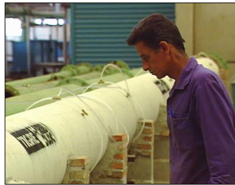
Ensaio da Rugosidade de Tubos de PVC RibLoc realizado na FCTH/EPUSP
